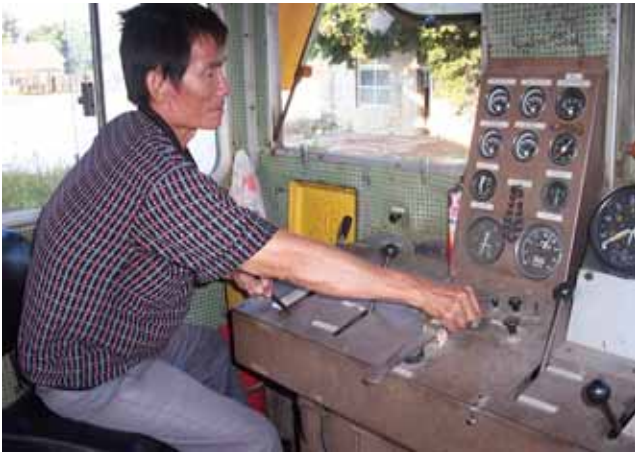
德馬牌機車駕駛室，司機先生正在轉動電門，發動引擎，準備開往目的地。
