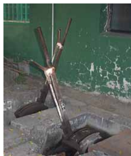
「轉撤器」白色半圓形在上，表示軌道換成正線，列車行進會以直行方向行駛。
